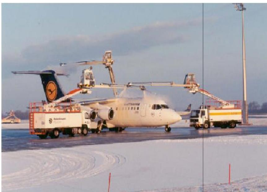
Повторное использование антиобледенителя в Мюнхенском аэропорту проводится уже с 1992 года. С помощью этого метода, после отделения нерастворимых компонентов, удаления растворенных веществ методом ионного обмена и завершающей стадии термического концентрирования, снова получают основной гликольсодержащий компонент для антиобледенителя.
